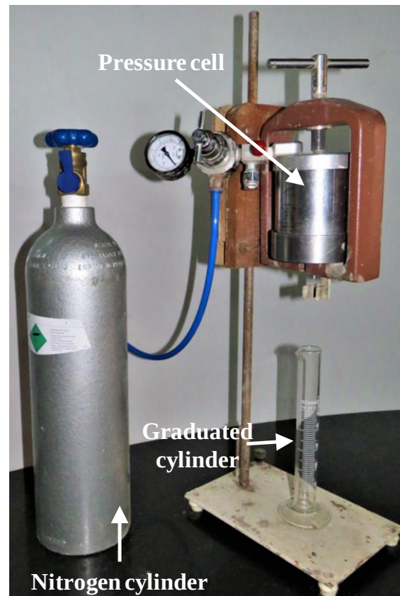
b) Actual test setup
