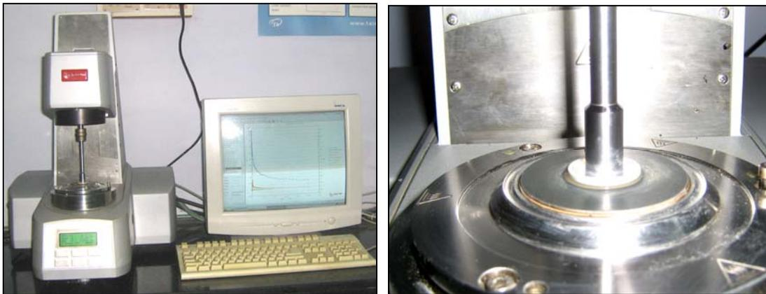
Fig. C.1(a) Anton Paar Rheometer
